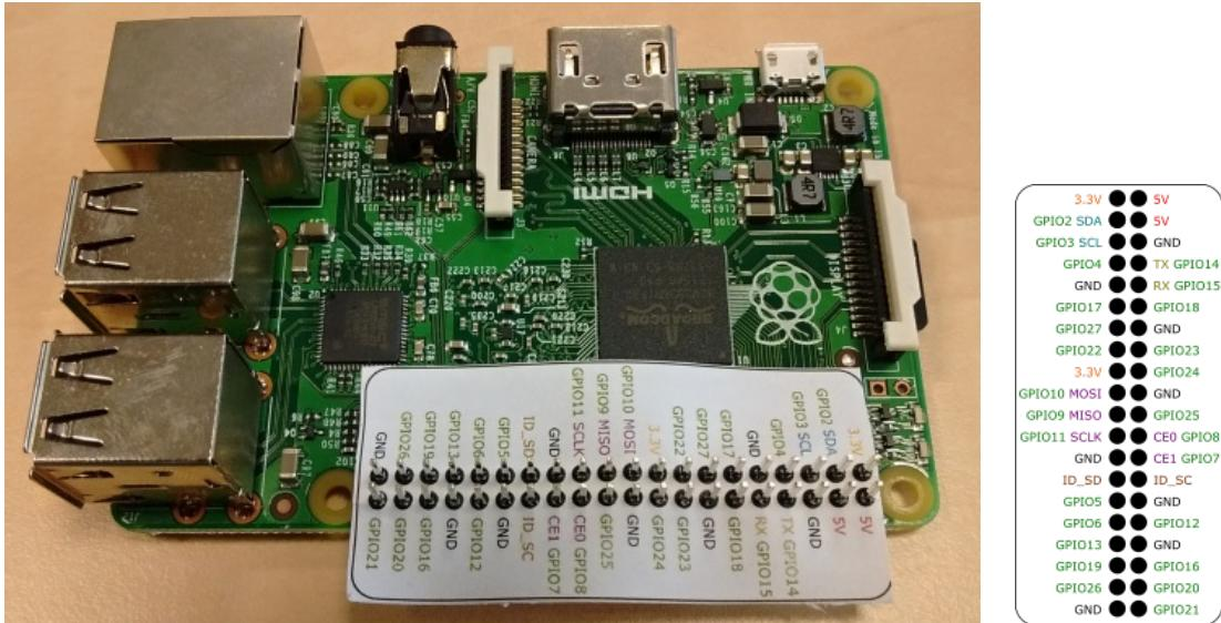
Obrázek 2.3: Označení GPIO pinů na Raspberry Pi.
