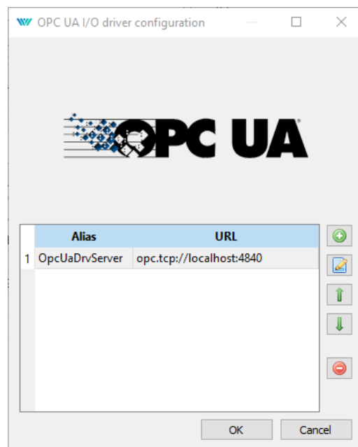
Obrázek 2.2: Ovladač ve módu OPC UA Klient – tabulka spojení
